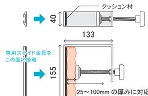
テーブルの凹凸や素材により、接着テープまたはビス取付が困難な場合に、固定を補助します。
